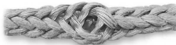
Comprimiendo el Cable a lo Largo
