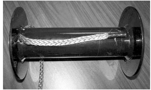
Cable sujetado al tambor con cinta
