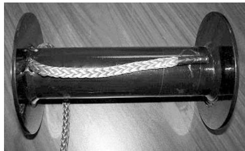
Corde fixée autour du tambour à l'aide du ruban adhésif
